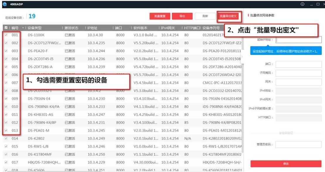
软件会根据设备类型自动导出 xml 文件 , 无法导出的会自动生成 out\_error 文档 , 并在 C 盘根目录下自动生成一个 SadpReset 文件夹 , 存放导出的 xml 文件、out\_error 文件。
